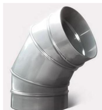
транспортировки пара, воды, среднеагрессивных и неагрессивных сред. Если необходима передача агрессивных сред, то отвод подвергается дополнительной оцинковке. Отводы 45° для круглых воздуховодов производятся из нержавеющей и оцинкованной стали и имеют толщину 1,0; 0,7 и 0,5 мм с размерами, указанными в таблице далее.
